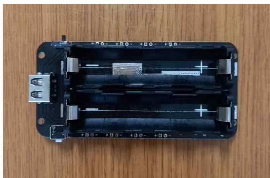
리튬 배터리 5V출력 및 자동 충전모듈(PN-HLCH-18650-2S)
