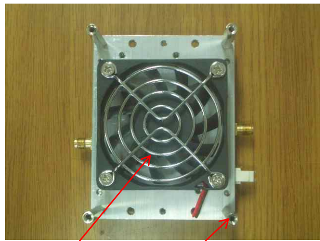
기본 알루미늄 방열판 전원 LED 고정용 홀(Hole) 팬(FAN) 케이스 고정용 육각보스
